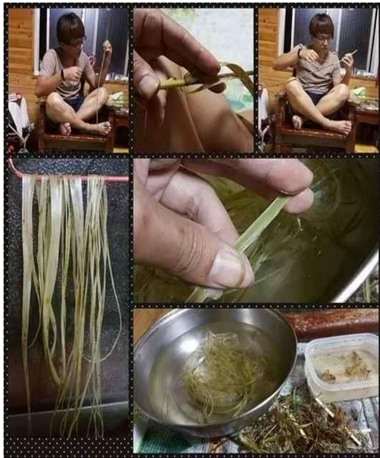
苧麻繩製作流程圖 / 莊志成 提供
